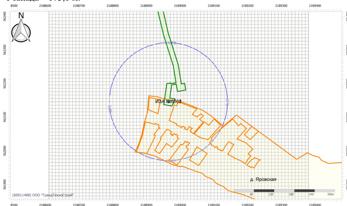
Рисунок 3 – Карта-схема распределения изолиний максимально-равных концентраций ЗВ при производстве работ в период строительства
