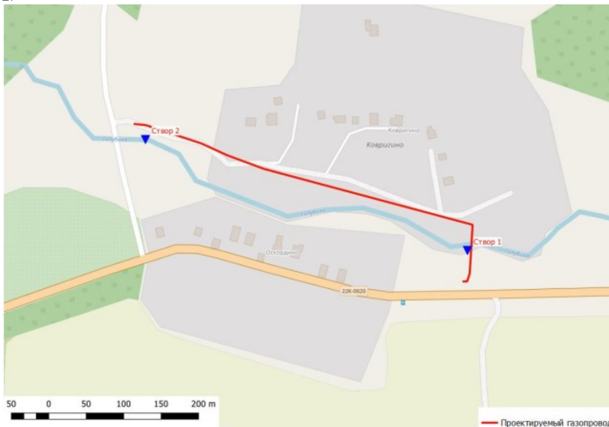
Рисунок 5 - Точки пересечения проектируемой трассы межпоселкового газопровода и поверхностных водных объектов.
