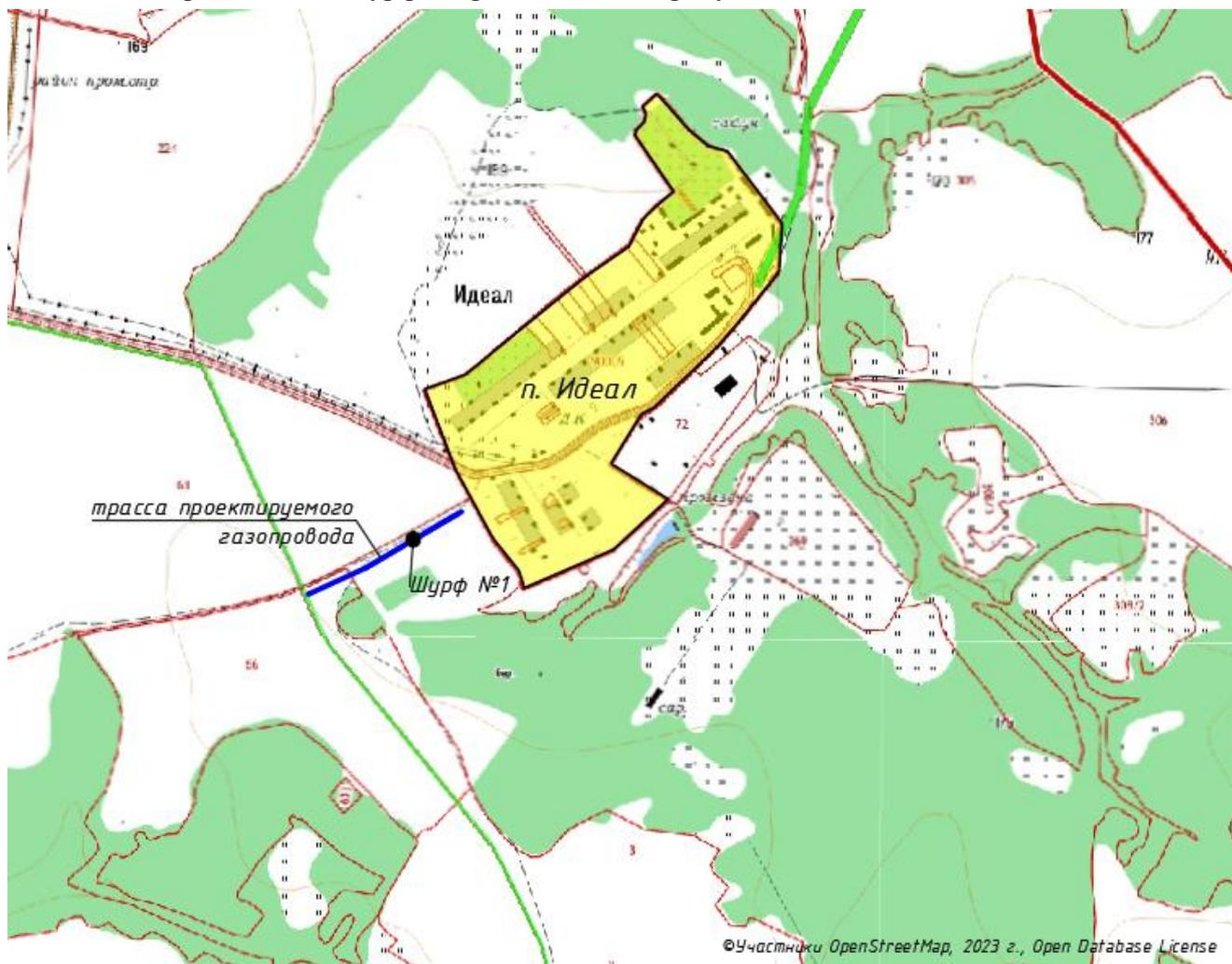
Рисунок 6 – Схема размещения шурфов
